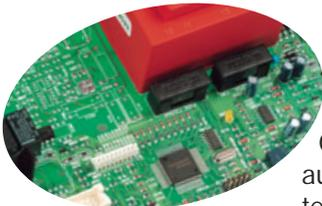
El microprocesador de Compy se encarga de controlar todos los parámetros de funcionamiento, así como las funciones de protección y de autodiagnóstico de la caldera, haciendo de ella una caldera fiable y segura.
